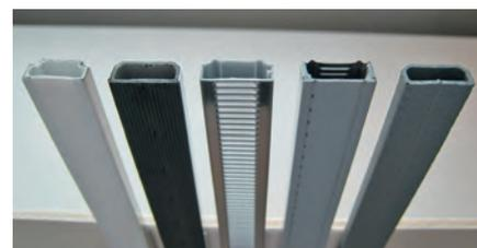
**Abbildung 2:** Hybridprofile aus Kunststoff mit Metall haben den Vorteil etwas besserer Psi-Werte. Teilweise werden sie in verschiedenen Farben und manche sogar mit passenden Warmen Sprossen angeboten.
