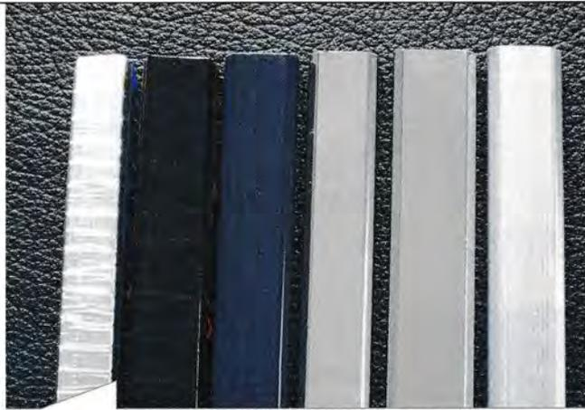
**Bild 3: Barrierefolien werden bei flexiblen Warme-Kante-Systemen (v. l. Profil 1 und 2) sowie zunehmend bei Profilstangen (Profile 3–6) verwendet. Augenscheinlich gibt es zwischen den Verbundfolien deutliche Unterschiede.**
